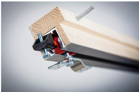
Kit guía para puertas correderas externas a la pared. Incluye, una guía de aluminio incrustada en madera, el kit carro y los tornillos de sujeción. El kit permite el montaje de panel de puerta de hasta 900mm de ancho, con un peso máximo de 80kg. Longitud estándar 2 metros
